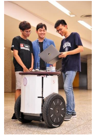
NVISION II 智慧自主機器人只靠一個相機鏡頭，就能躲避靜態與動態的障礙物，也可以跟隨行走中的人。
