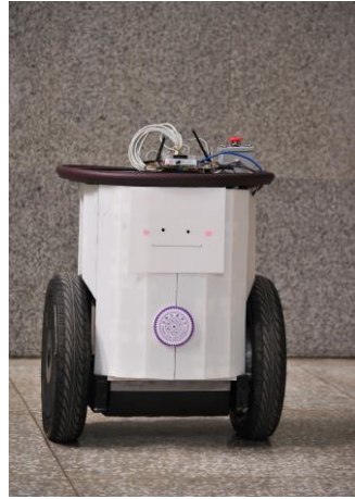
團隊打造的「NVISION II 智慧自主機器人」啟動後能靠兩個輪子自行保持平衡。
