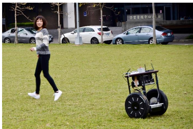
經過在虛擬世界的訓練，NVISION II 智慧自主機器人在現實世界中可以跟隨行走中的人。
