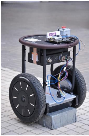
NVISION II 智慧自主機器人只靠一個視訊鏡頭來「看」世界，就能躲避靜態與動態的障礙物，也可以跟隨行走中的人。
