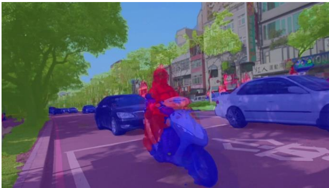
NVISION II 智慧自主機器人將鏡頭看到的真實場景，以視覺辨識技術轉換為機器人能理解的圖像語義分割影像，人變成紅色的色塊，移動的車輛則變成藍色。
