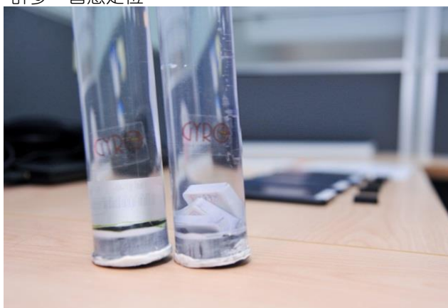
捷螺研發團隊將智慧晶片泡在水裡一年，測試其防水性。
