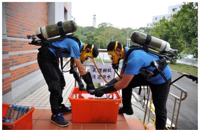
有些老舊鋼瓶依據氣體性質處理後，需將氣瓶閥移除，並浸泡處理以中和瓶身內部殘餘化學物質的毒性
