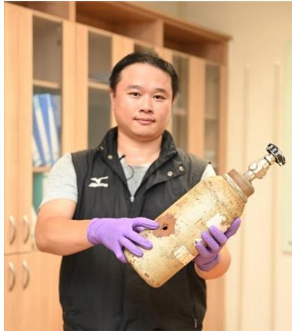
本校環安中心塗佳霖助理工程師展示已擊穿、釋出危害氣體的老舊氣體鋼瓶
