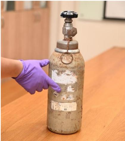
部分老舊氣體鋼瓶瓶身布滿紅色鐵鏽、標示磨損不清，閥門也無法打開
