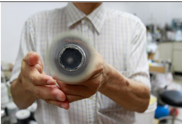
電觸媒蜂巢為一全新的促進氮氧化物分解(PND)技術的裝置。
