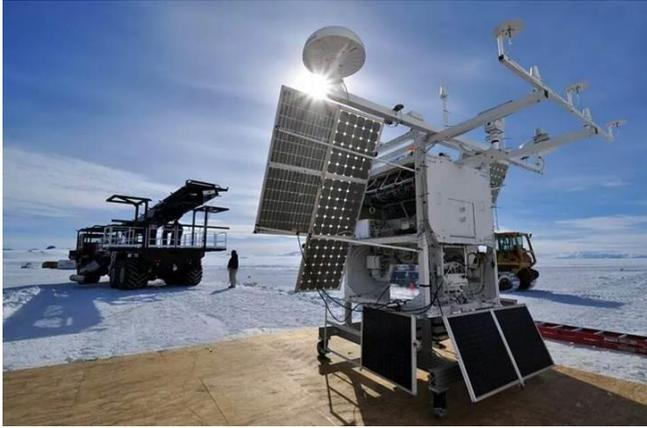
康卜吞成像光譜儀置放在白色的高空氣球載架中。圖中正上方半圓球形物體是鈦衛星天線。
