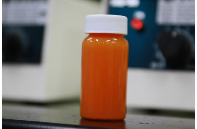
段興宇教授研究團隊耗時一年多，實驗過數百種材料後，發現使用三碘化磷為原料，在室溫下只要 5 分鐘就可合成出「摻碘的紅磷奈米粒子」。
