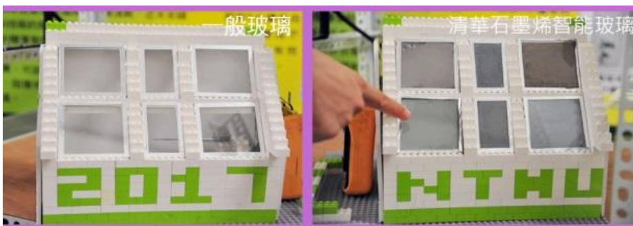
經強光照射 2 分鐘後，一般玻璃(左)仍呈透明，清華石墨烯智能玻璃(右)已變不透明，阻隔光線與熱能，室內比較涼爽。
