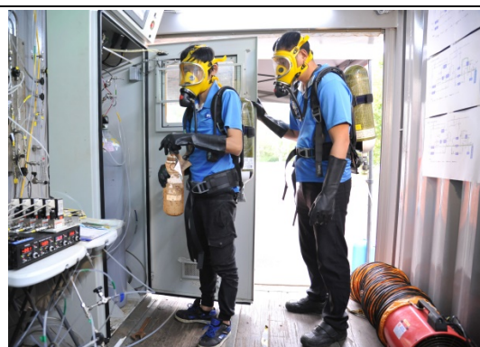
操作人員穿上防護裝備處理老舊氣體 鋼瓶
