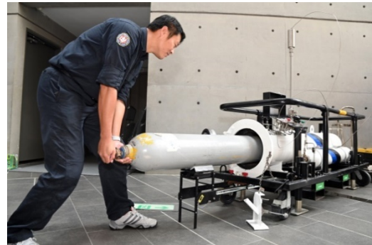
老舊鋼瓶被放進填充惰性氣體的密閉艙體內，避免擊穿時產生火花、燃燒爆炸
