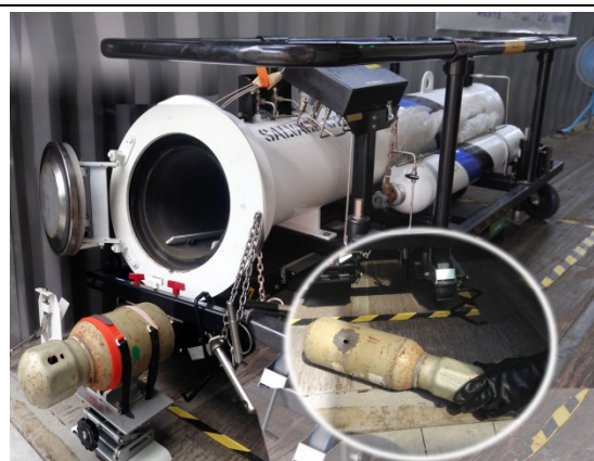
老舊鋼瓶被放進填充惰性氣體的密閉 艙體內，避免擊穿時產生火花、燃燒爆 炸
