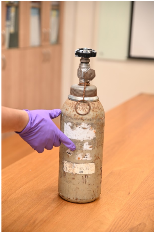
部分老舊氣體鋼瓶瓶身布滿紅色鐵鏽、標示磨損不清，閥門也無法打開
