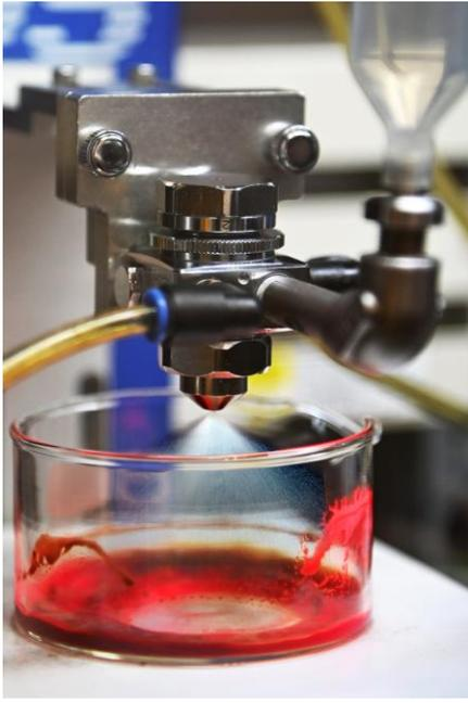
用噴霧合成法來製備鈣鈦礦量子點可增加接觸表面積，在量子點外表包覆一層均勻的有機保護層
