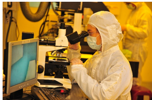
清華半導體學院學生未來將可在黃光實驗室內上實驗課，用顯微鏡觀測曝光顯影結果
