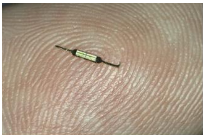
手指上是僅 0.2 公分的超音波元件和迷你探頭，可深入血管溶解血栓
