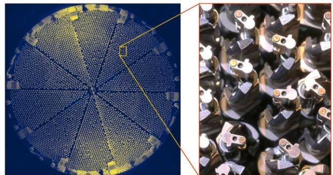
暗能量光譜儀前端的 5 千個獨立小型機器人排列成塊一塊切成 10 片的披薩狀大圓，能捕捉天空中的光波。
