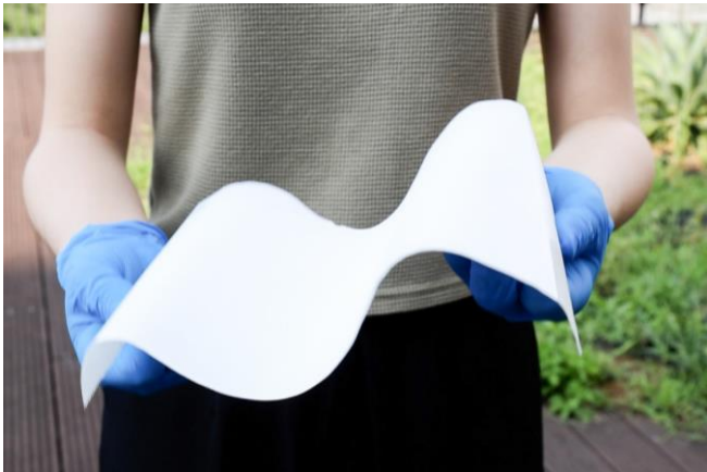
「超冷奈米纖維」以陶瓷製成，材料輕薄可彎曲、不易破損且耐酸雨。
