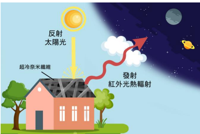
超冷奈米纖維能反射 97% 太陽光，並將熱能轉為紅外光，輻射到外太空。
