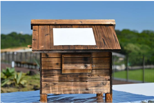
將超冷奈米纖維鋪在模型屋屋頂，溫度即從攝氏 50 度降到 29 度。
