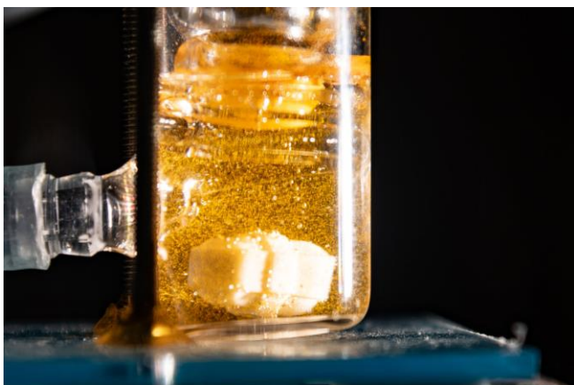
在海水中加入團隊研發的高分子催化劑後，透過光照，即產生氫氣氣泡。
